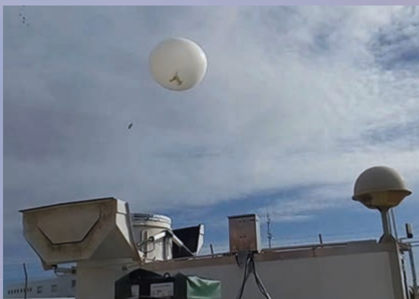
El globo sonda, saliendo de la estación de lanzamientos automáticos.
